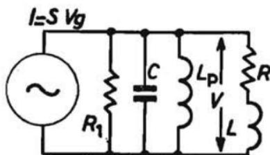
Fig. 126. - Circuito equivalente del trasformatore di uscita.
