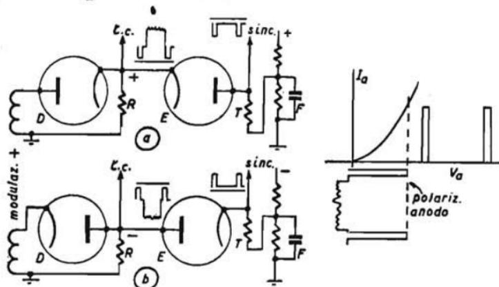
Fig. 104. - Diodi separatori.
