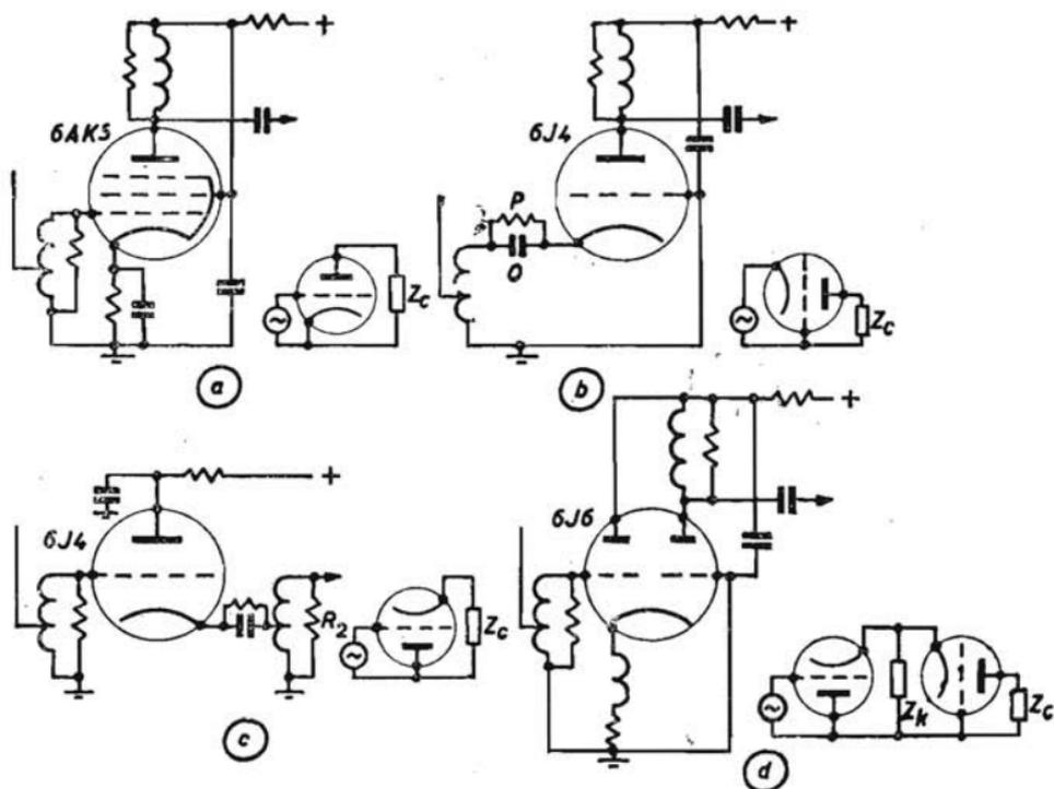
Fig. 39. - Circuiti dello stadio in A.F.
