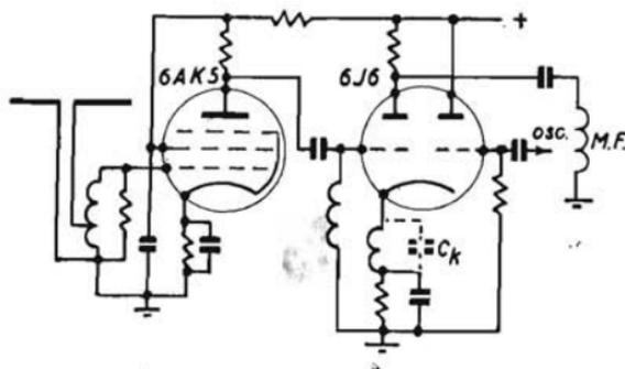
Fig. 42. - Doppio triodo convertitore con accoppiamento catodico.
