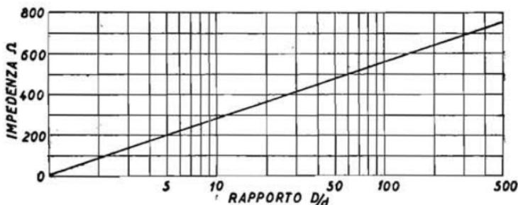
Fig. 18. - Impedenza caratteristica di una linea bifilare.
