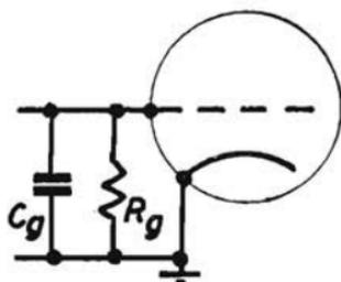
Fig. 35. - Impedenza di entrata di un tubo.
