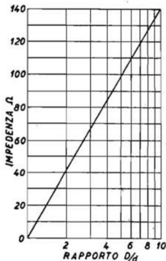
Fig. 19. - Impedenza caratteristica di un cavo coassiale.
