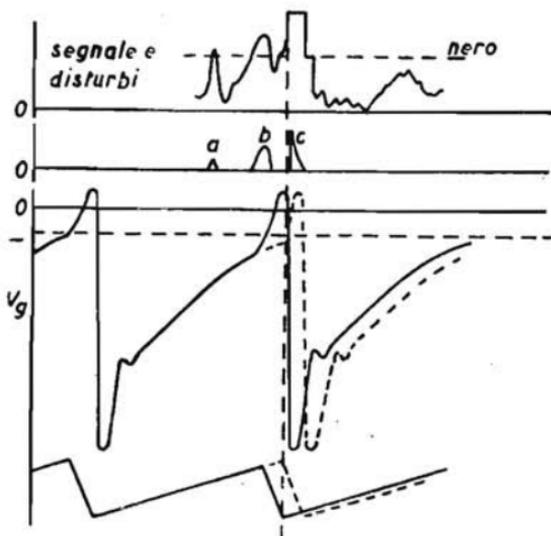
Fig. 115. - Perdita del sincronismo a causa di disturbi (modulazione negativa).
