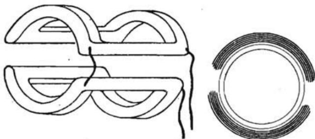
Fig. 123. - Bobine di deviazione.
