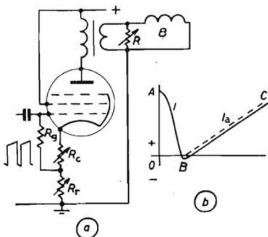
Fig. 128. - Stadio finale di deviazione elettromagnetica.
