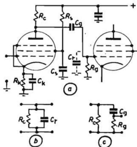
Fig. 77. - Accoppiamento a resistenza capacità.
