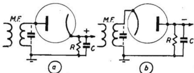
Fig. 71. - Rivelatori a diodo.
