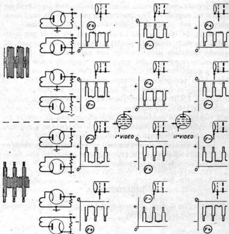
Fig. 74. - Rivelazione e fase del segnale video.
