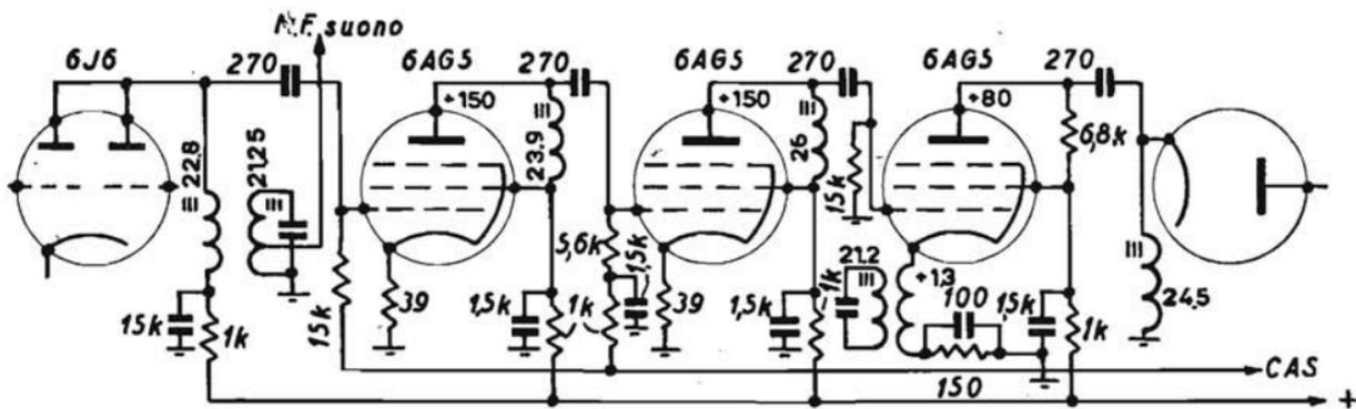
Fig. 55. - Amplificatore di M. F. del televisore RCA 730TV1.
