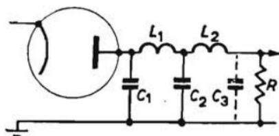
Fig. 72. - Cellule di filtro per A. F.
