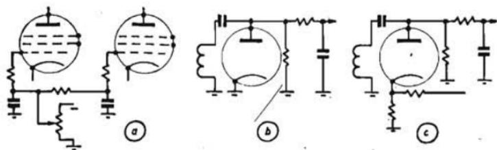
Fig. 63. - Schemi per il controllo del contrasto.
