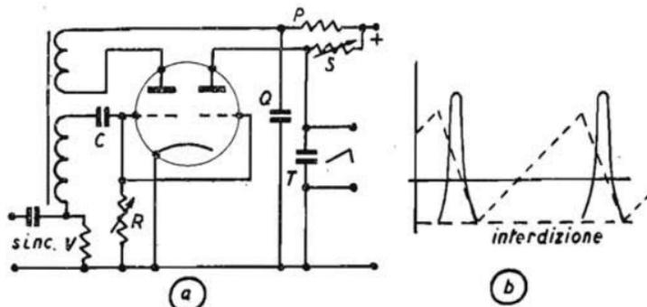
Fig. 98. - Oscillatore di blocco con doppio triodo.
