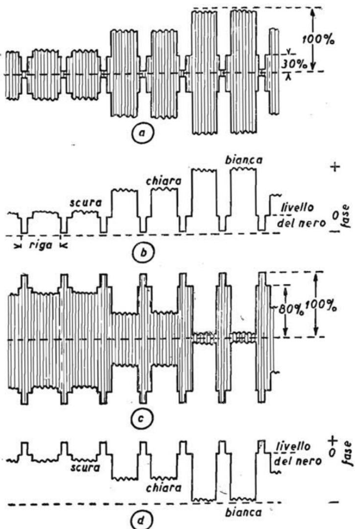
Fig. 11. - Modulazione della portante di un trasmettitore di televisione. In *a*) portante con modulazione positiva ed in *b*) segnale rivelato corrispondente. In *c*) portante con modulazione negativa ed in *d*) segnale rivelato corrispondente.
