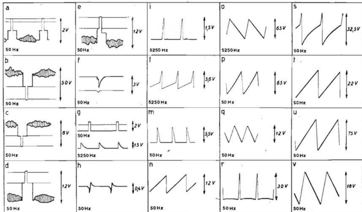
Fig. 122. - Oscillogrammi ottenuti nei vari punti del circuito di fig. 121.
