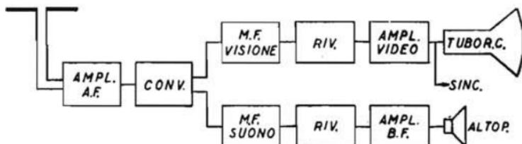
Fig. 26. - Ricevitore di televisione con circuito supereterodina.
