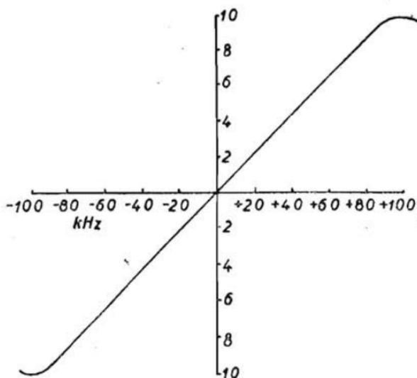
Fig. 66. - Caratteristica di un discriminatore.
