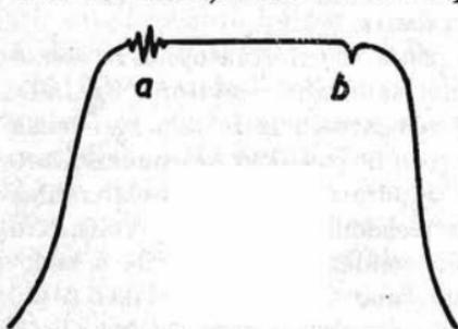
Fig. 29. - Curva di selettività di un televisore con indici a frequenze prestabilite.
