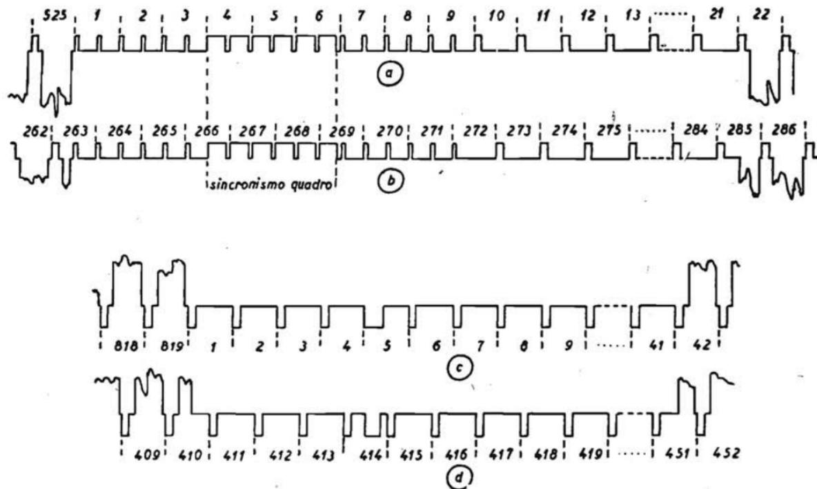
Fig. 12. - Segnali di sincronismo riga e quadro secondo lo standard americano, in *a*) per i quadri dispari ed in *b*) per i pari. In *c*) e *d*) i corrispondenti segnali dello standard francese.
