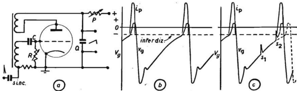
Fig. 97. - Oscillatore di blocco. Nucleo ferro silicio  $17 \times 17$ . Avvolgimenti di 3000 spire 0,08 ciascuno per frequenza quadro.
