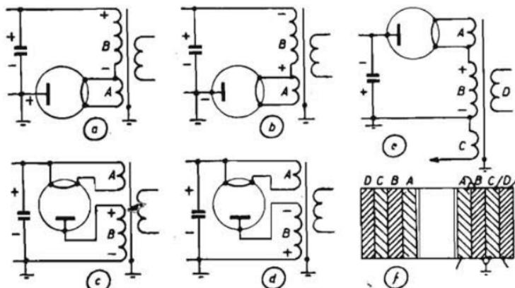
Fig. 143. - Isolamento fra gli avvolgimenti di un trasformatore A. T.
