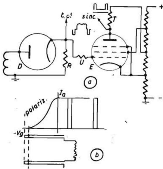
Fig. 105. - Pentodo limitatore separatore.
