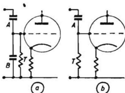
Fig. 101. - Partitori di tensione per entrata di amplificatori.
