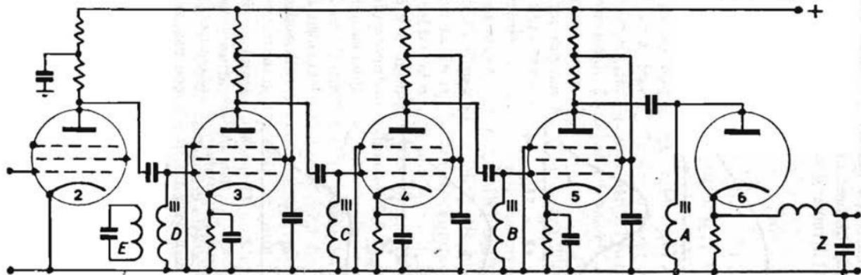
Fig. 52. - Amplificatore di M. F. a circuiti accordati.
