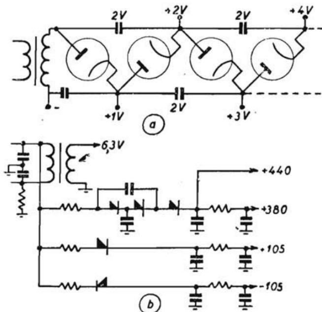
Fig. 146. - Principio generale di moltiplicatore di tensione e alimentatore multiplo per basse tensioni di un televisore.
