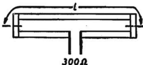
Fig. 15. - Dipolo ripiegato.
