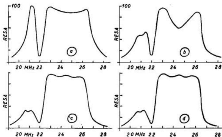
Fig. 58. - Curve di selettività dei vari stadi dell'amplificatore di M. F. visione del televisore G.E. 802.
