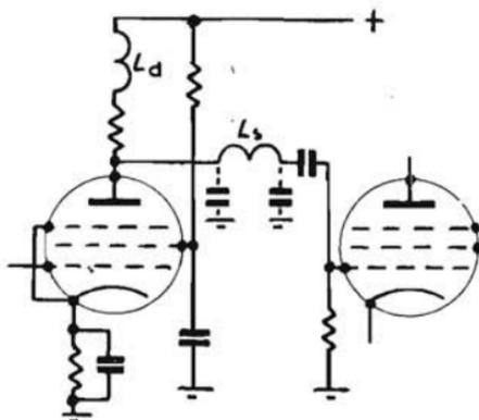
Fig. 81. - Accoppiamento a resistenza capacità con compensazione in derivazione ed in serie.
