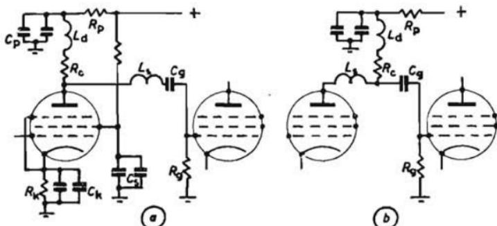
Fig. 83. - Amplificatori video compensati.
