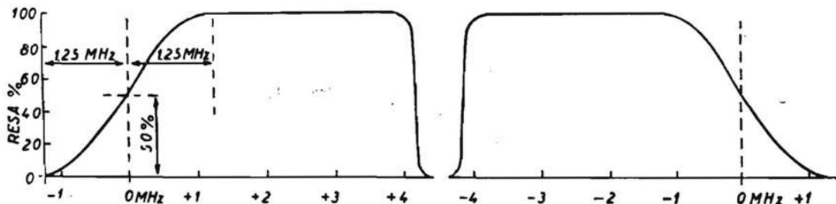
Fig. 50. - Curva di selettività di un amplificatore di M. F.
