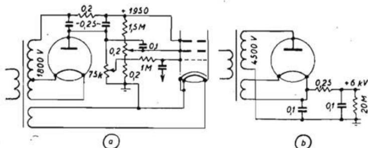
Fig. 142. - Alimentatori con trasformatori A. T.
