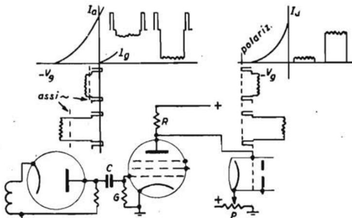
Fig. 92. — Amplificatore video autopolarizzato con accoppiamento diretto col tubo catodico (modulazione positiva della portante).
