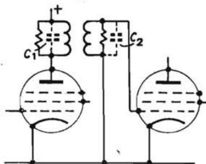
Fig. 56. - Accoppiamento fra stadi con circuiti sovraccoppiati.
