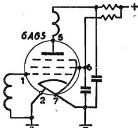
Fig. 38. - Tubo con doppio collegamento al catodo per ridurre l'effetto di controreazione relativo.
