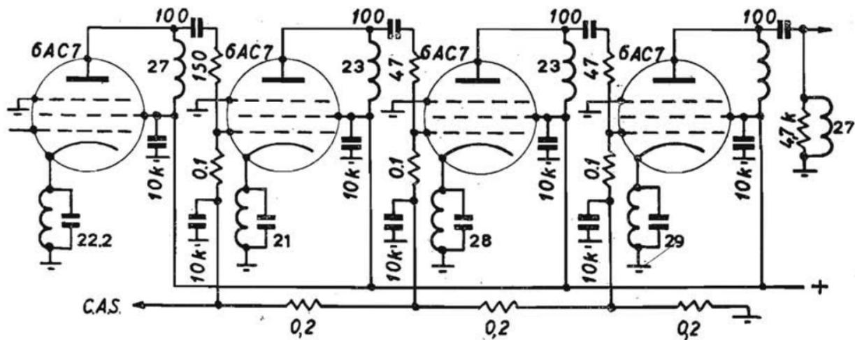
Fig. 62. - Amplificatore di M. F. della visione, con filtri, del televisore Consolidated Television.
