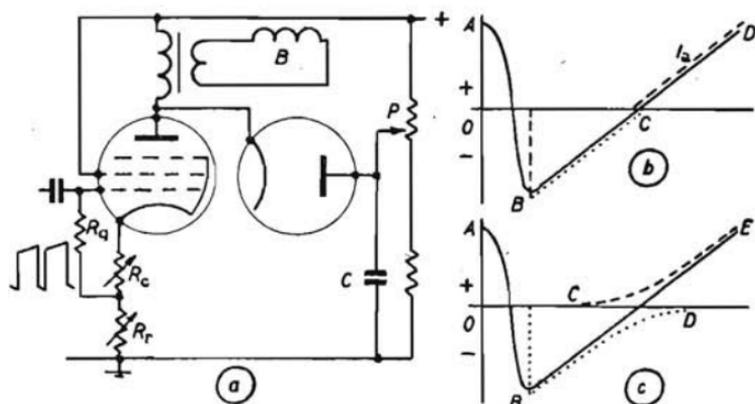
Fig. 129. - Stadio finale di deviazione elettromagnetica con diodo di smorzamento.
