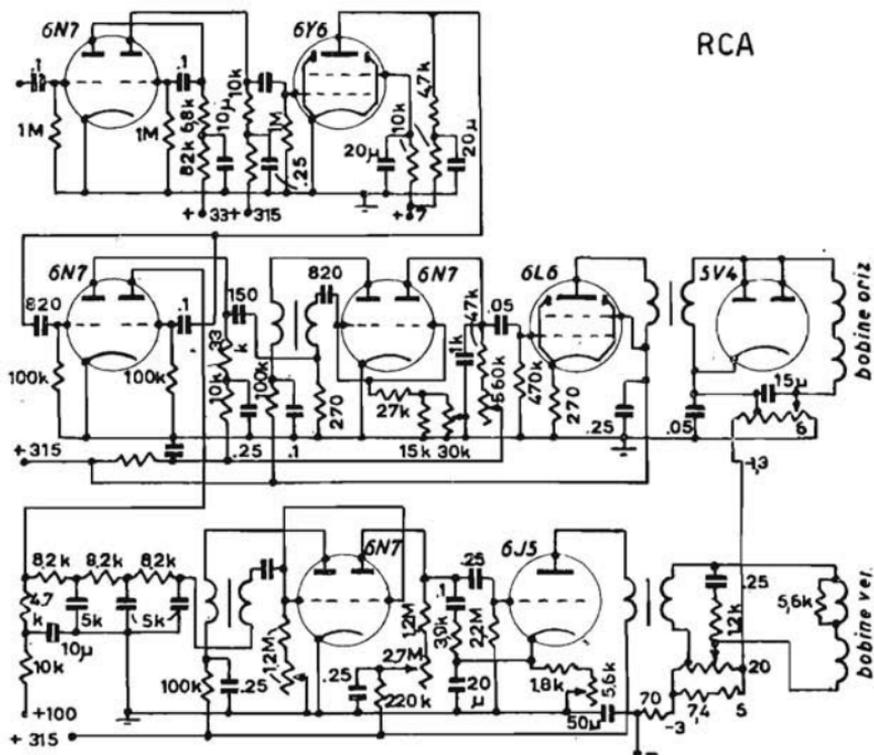
Fig. 136. - Complesso di deviazione elettromagnetica della RCA.
