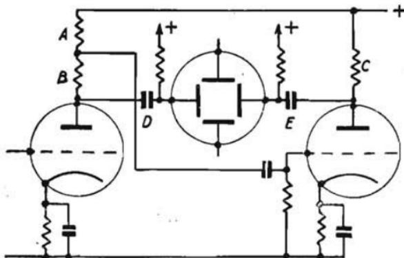
Fig. 119. - Amplificatore in confase per deviazione elettrostatica.
