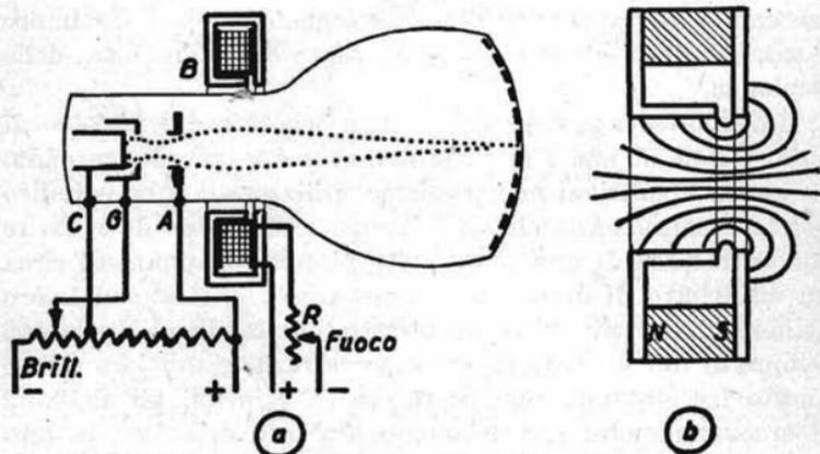
Fig. 2. - Tubo catodico con concentrazione elettromagnetica del fascetto di elettroni. In *b*) alla bobina di eccitazione è stato sostituito un magnete permanente. Le linee piene indicano l'andamento delle linee di forza del campo magnetico di piccola lunghezza.
