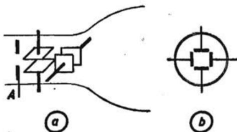
Fig. 5. - Tubo catodico con coppie di placchette per la deviazione elettrostatica.
