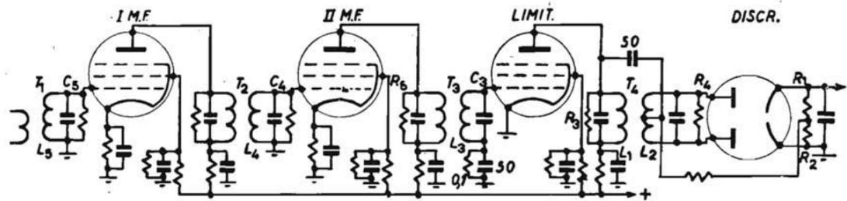
Fig. 67. - Amplificatore di M. F. con discriminatore.
