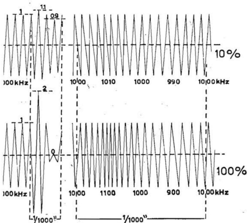
Fig. 10. - Modulazione in ampiezza e in frequenza.
