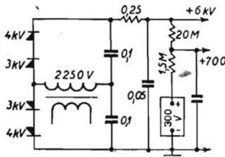
Fig. 145. - Duplicatore di tensione con raddrizzatore ad ossido.
