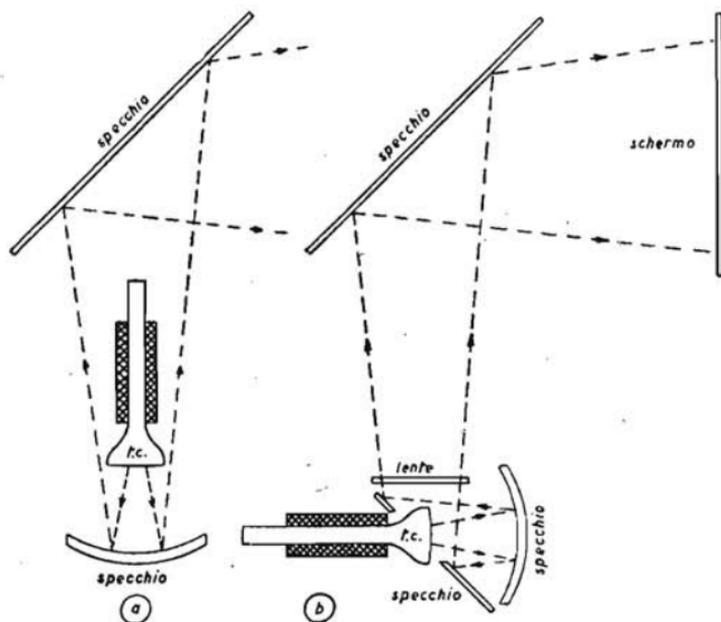
Fig. 152. - Sistema ottico Schmidt per proiezione.
