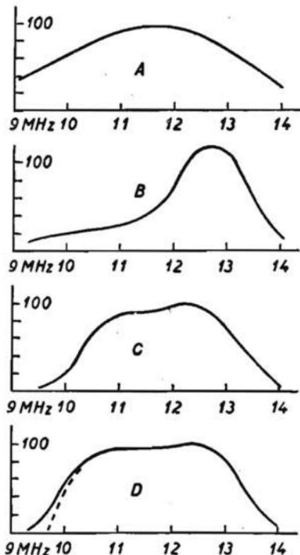
Fig. 53. - Curve di selettività successive risultanti dall'allineamento dell'amplificatore di fig. 52.
