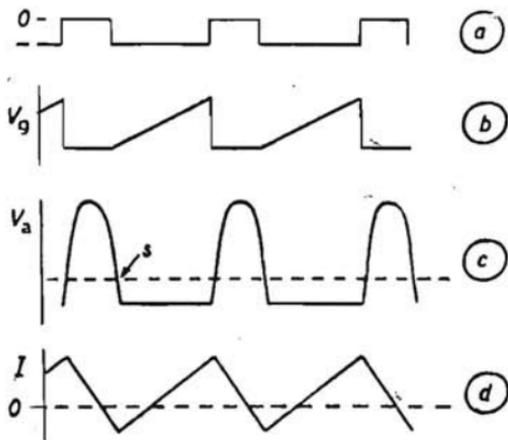
Fig. 131. - Tensioni e correnti nel circuito di fig. 130.
