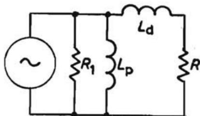
Fig. 134. - Circuito equivalente del trasformatore di quadro.
