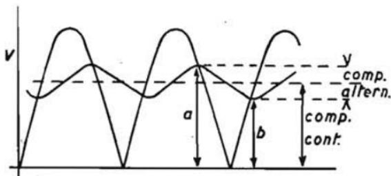
Fig. 85. - Funzionamento di un raddrizzatore biplacca.
