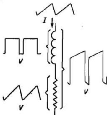
Fig. 125. — Corrente nelle bobine di deviazione e tensione applicata.
