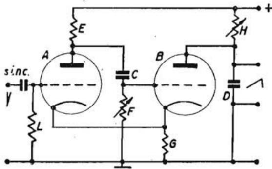
Fig. 99. - Multivibratore a denti di sega.
