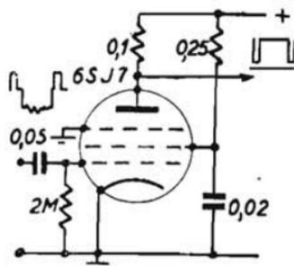
Fig. 106. - Pentodo separatore autopolarizzato.
