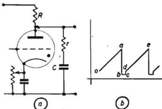
Fig. 100. - Oscillatore con resistenza in serie alla capacità.
