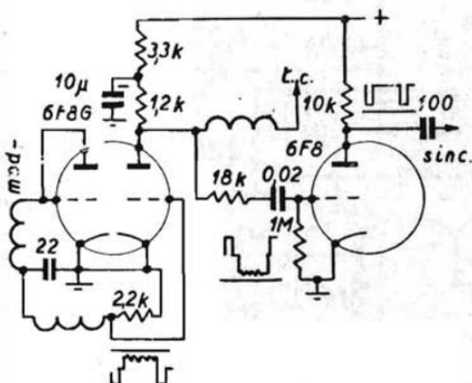
Fig. 109. - Separatore RCA.
