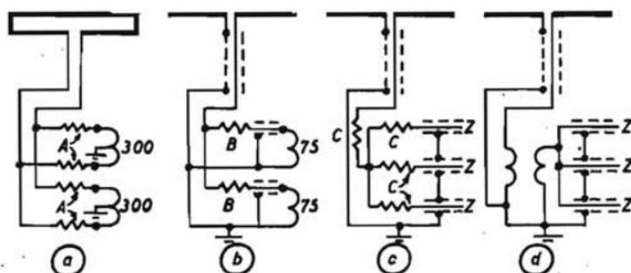
Fig. 22 - Collegamento di più televisori su di un dipolo.
