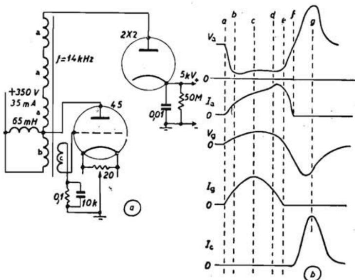
Fig. 151. - Oscillatore di blocco Hazeltine per alimentatore A. T. Le bobine
