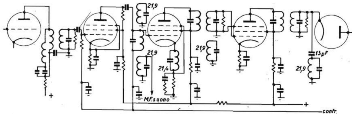
Fig. 61. - Amplificatore di M. F. della visione con filtri, del televisore G.E. 802.
