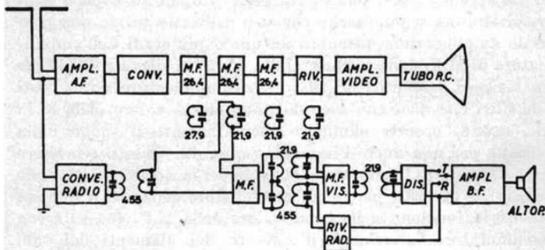
Fig. 27. - Schema di principio del ricevitore General Electric modello 801.
