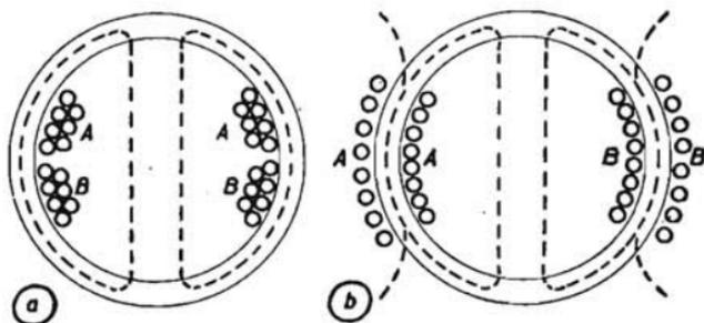
Fig. 138. - Nuclei di condensazione del campo magnetico prodotto da una coppia di bobine di deviazione.
