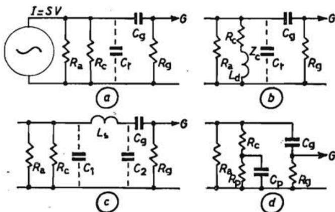
Fig. 78. - Circuiti equivalenti e compensazioni.
