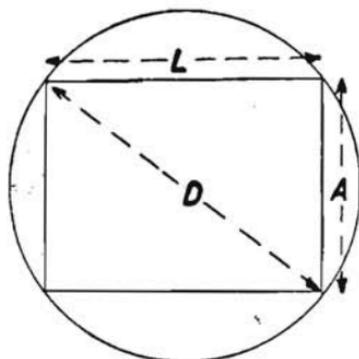
Fig. 118. - Dimensioni dell'immagine relativa al diametro dello schermo.
