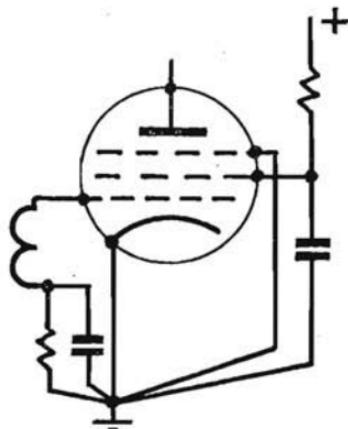
Fig. 40. - Tubo convertitore con autopolarizzazione per corrente di griglia.
