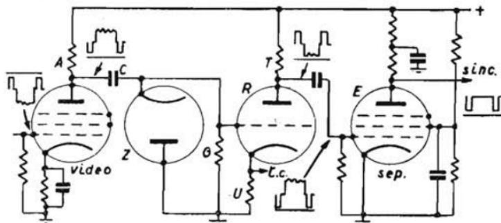
Fig. 111. - Complesso amplificatore separatore.
