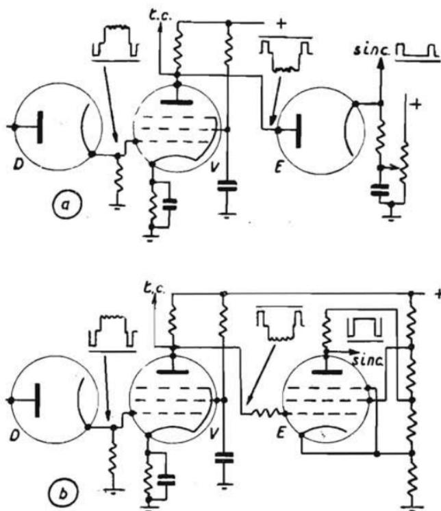
Fig. 107. - Separatori seguenti l'amplificatore video ad accoppiamento diretto.
