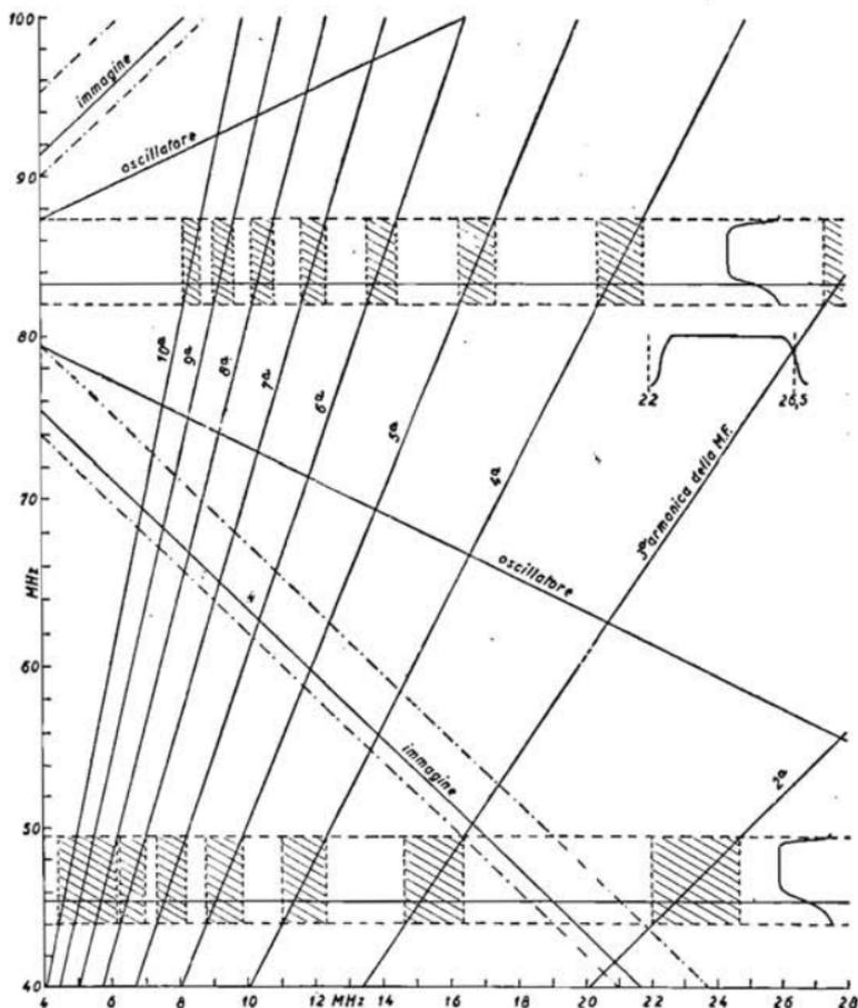
Fig. 49. - Valori della M. F. le cui armoniche possono interferire con il canale ricevuto (le superfici tratteggiate indicano le zone di interferenza).
