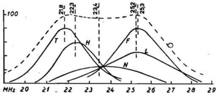
Fig. 54. - Curves di selettività dei circuiti dell'amplificatore di M. F. del televisore RCA648PTK (schema nel cap. 11).
