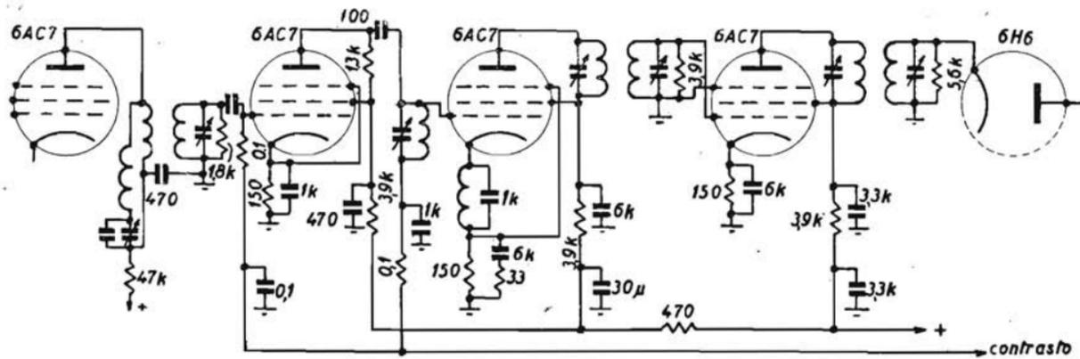
Fig. 57. - Amplificatore di M. F. del televisore G. E. 802.
