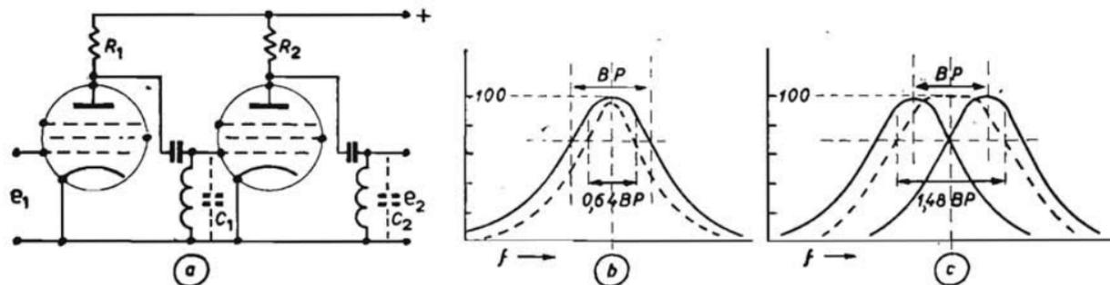
Fig. 51. - Amplificatore di M. F. con circuiti accordati e curve di selettività risultanti.
