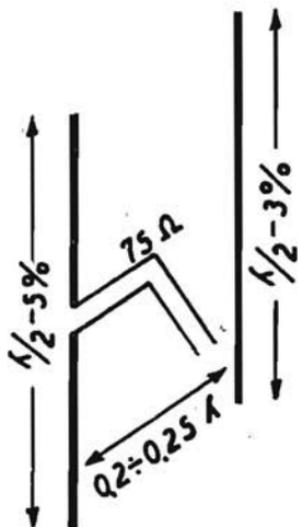
Fig. 16. - Dimensioni di un dipolo con riflettore.
